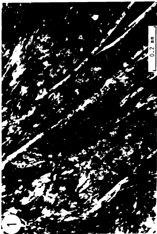
MICROFOTOGRAFÍA 1. Cristales fibrosos y aciculares de antigorita con acusada heterometría de tamaño, atravesando la trama de la serpentina. Polarizadores cruzados.
