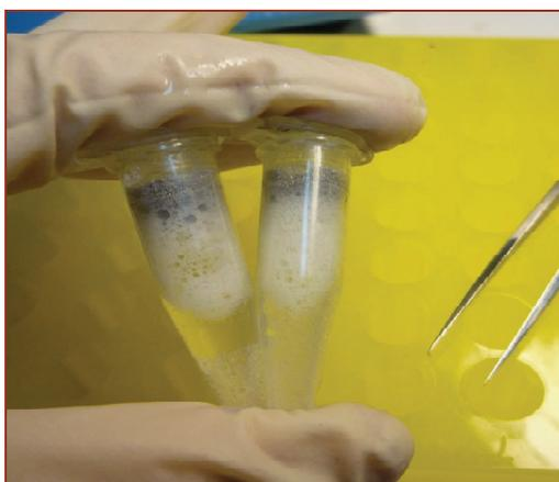
**Figura 5.4.** Muestras con filtro y solución de lavado
