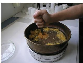
Figura 3. Tamizado con tamiz de 0.25 mm de luz de rejilla.
