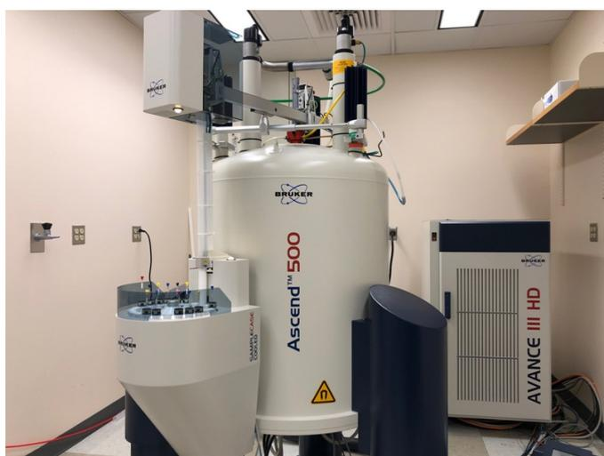
**Imagen 17.** Espectómetro de RNM Bruker Ascend 500
