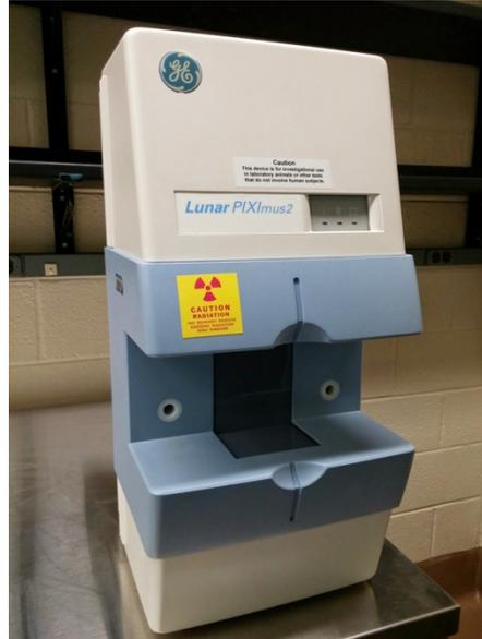
**Imagen 11.** Densitómetro Lunar Piximus utilizado para el análisis de las muestras.
