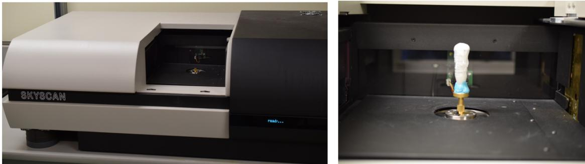
**Imagen 12:** A la izquierda, aparato de microtomografía computarizada SkyScan1172; SkyScan . A la derecha disposición de la muestra sobre el soporte giratorio del aparato.
