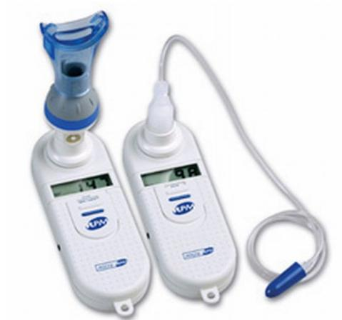
**Figura 7.** Manómetro respiratorio bucal MicroRPM
