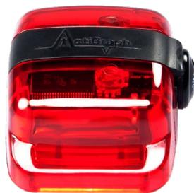
**Figura 2.** Acelerómetro triaxial Actigraph GT3X
