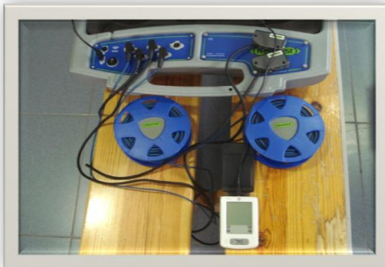
Figura 3.2. Dispositivo *Newtest* 300.
