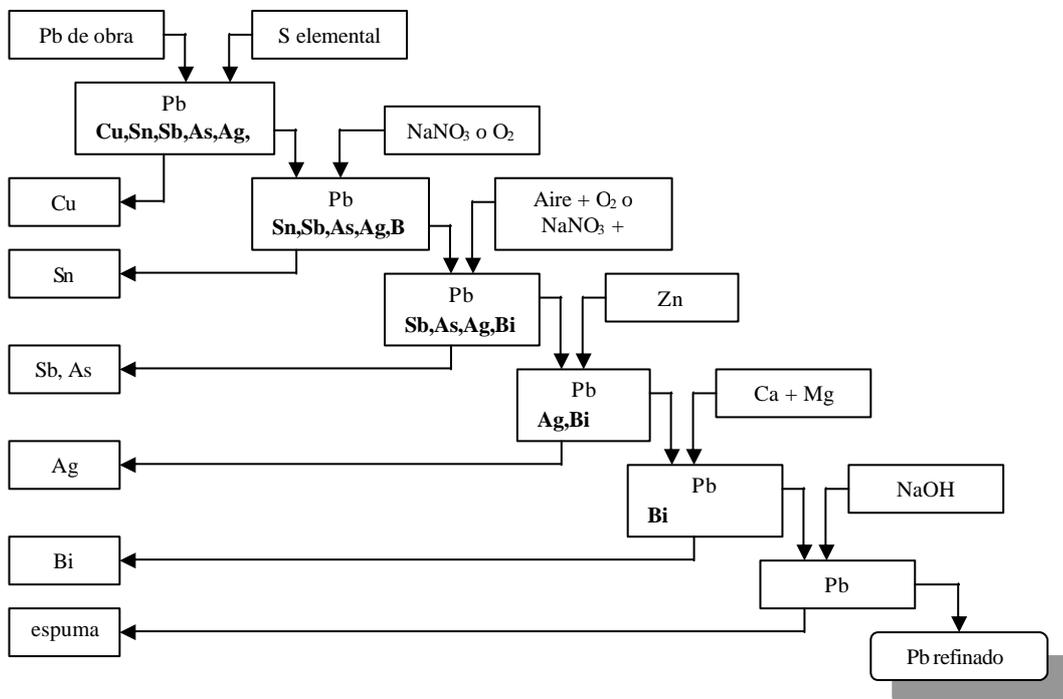
Figura 2. Refino pirometalúrgico del plomo.
