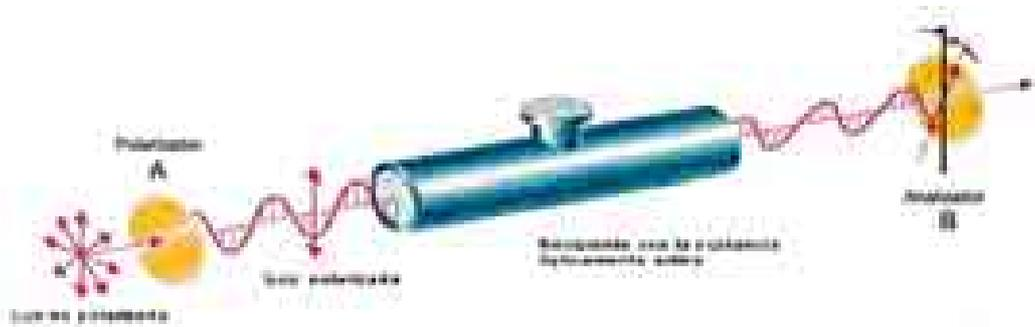
*Esquema de un polarímetro*
