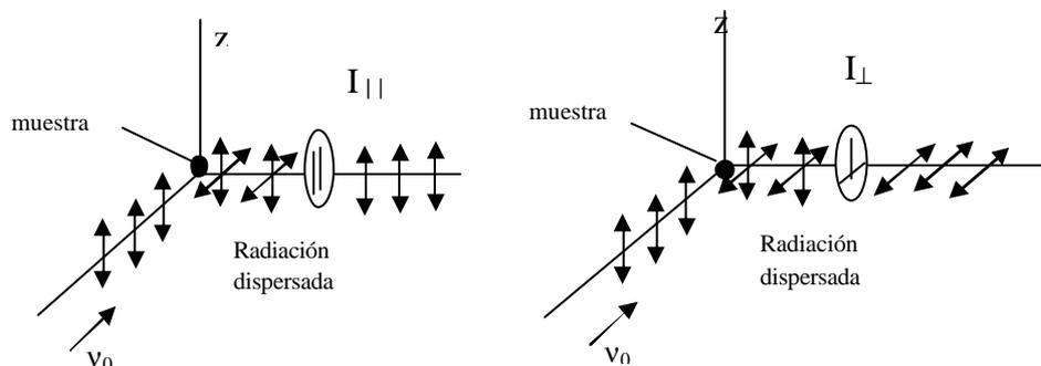
*Esquema para la medida experimental del grado de despolarización.*
