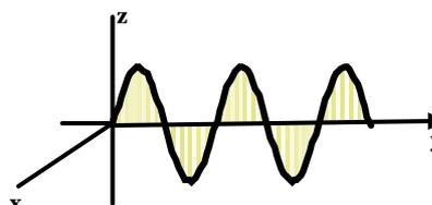
La luz blanca está formada por ondas que fluctúan en todos los planos que contienen a su línea de propagación, representados por flechas en la figura. Existen materiales, llamados “polarizadores”, que tienen la propiedad de que sólo permiten el paso de la luz que vibra en un plano específico. La luz emergente recibe el nombre de “luz polarizada”. Si la luz polarizada incide sobre otro polarizador, sólo podrá atravesarlo en el caso de que sus planos de polarización coincidan.
