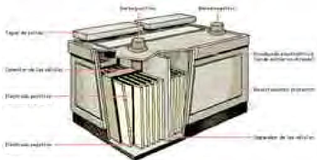
Figura 1. Componentes y estructura interna de los acumuladores de plomo.
