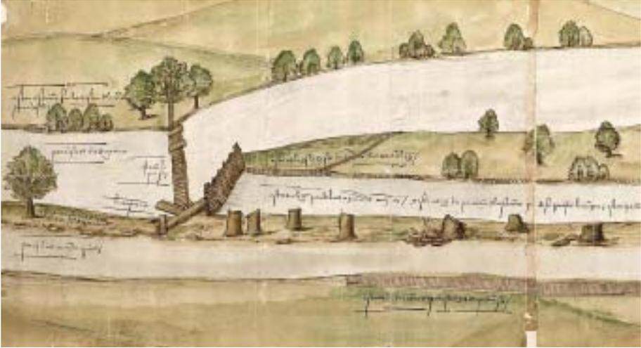
Detalle del trenzado vegetal del final del canal del socaz del molino de Guriezo.
