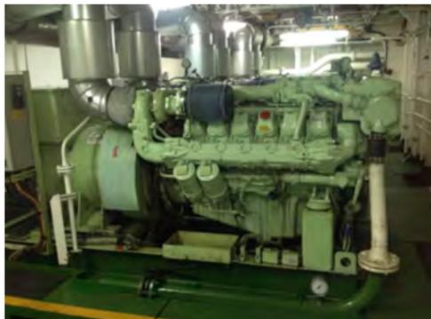
Ilustración n.º2: Motor auxiliar a bordo. Fuente: Trabajo de campo.
