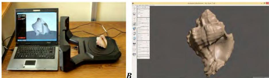
Fig. 3. Proceso de creación del modelo 3d de un fósil. A Makerbot Digitizier donde se observa el plato giratorio con el fósil de *Persististrombus latus*, y la figura en proceso de escaneado de forma automática. B. Edición en el programa gratuito Meshmixer del modelo 3D del fósil *Hexaples trunculus* escaneado.
