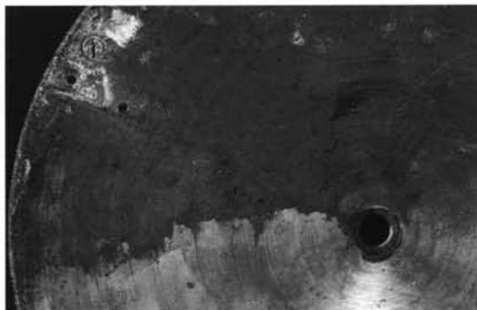
FIGURA 12: DETALLE DE FOCOS DE CORROSIÓN ACTIVA, GRASA Y SUCIEDAD ACUMULADA. PROCESO DE LIMPIEZA DE LA BRÚJULA.
