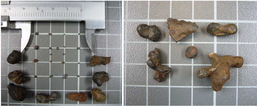
Figs. 436 y 437: Gotas de fundición, de < de 1 mm. a 2 cm.
