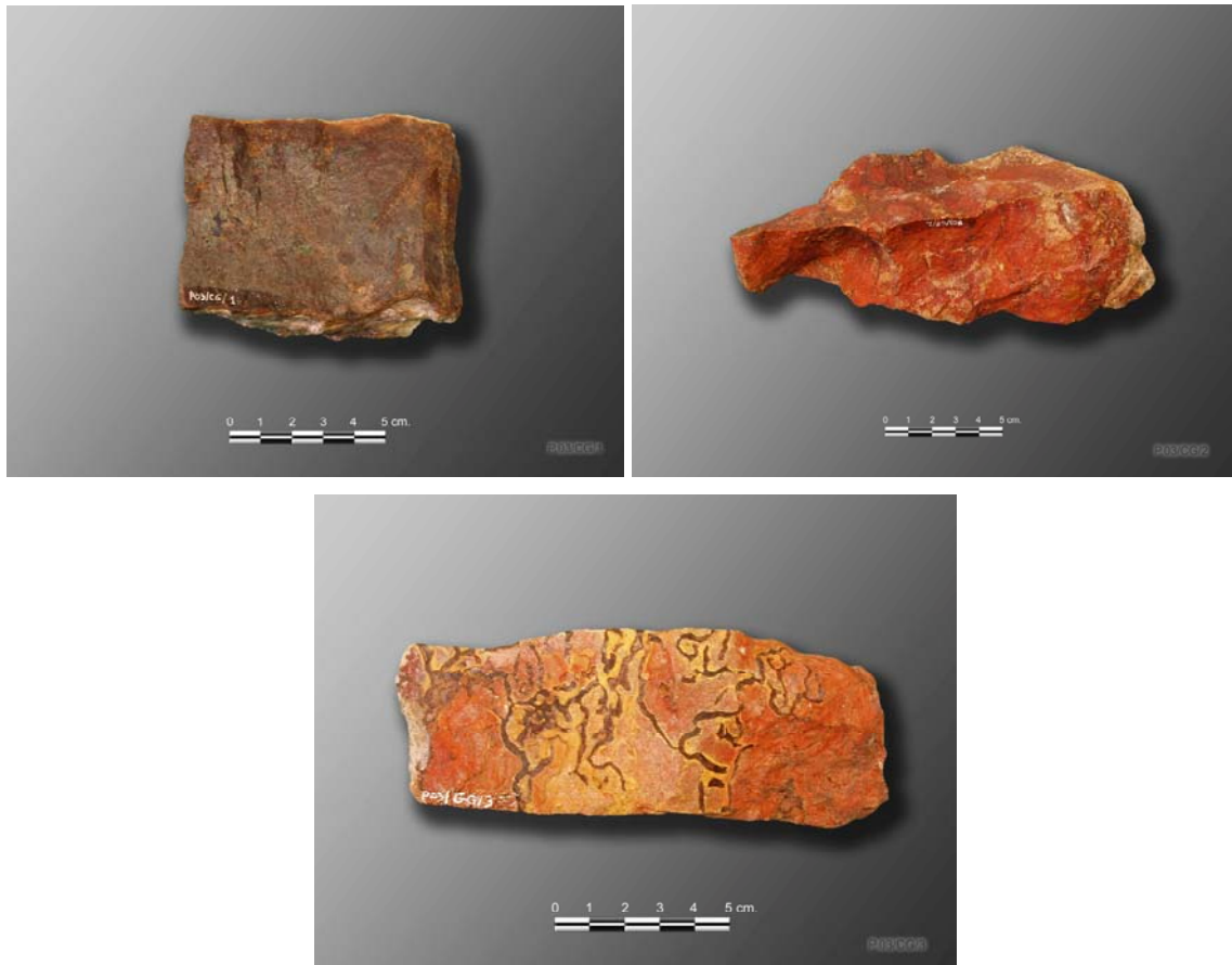
Figs. 24-26: Muestras de mineral de hierro P.03-CG-1, 2 y 3, recogidas en las prospecciones del alto Iregua en 2003. (Oligisto brillante, Hematites roja y Hematites parda)
