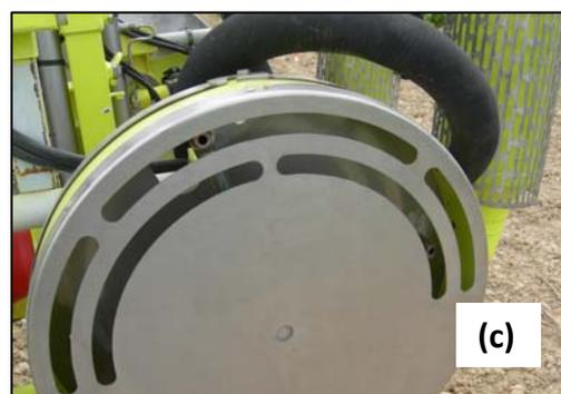
**Figura 3.3.** Deshojadora de impulsión de aire Collard®, (Collard, Francia) utilizada en los tratamientos de deshojado. **(a)** vista posterior; **(b)** vista lateral; **(c)** detalle del cabezal lateral con dos boquillas visibles.
