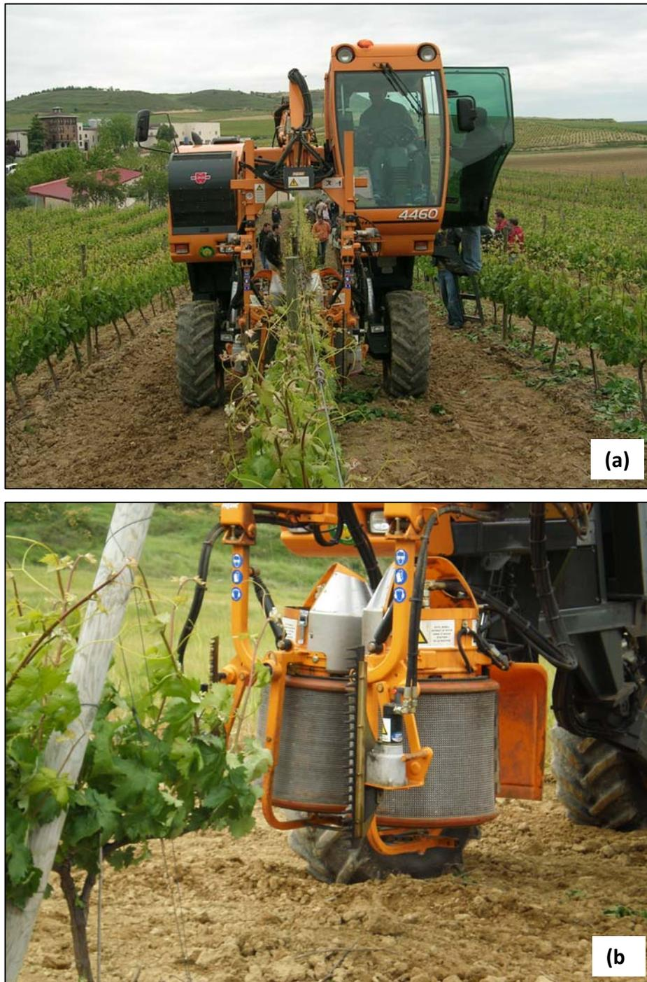
**Figura 3.5.** Deshojadora de aspiración y corte Pellenc® (Pellenc, Francia). **(a)** Vista general; **(b)** Detalle de los tambores rotatorios.
