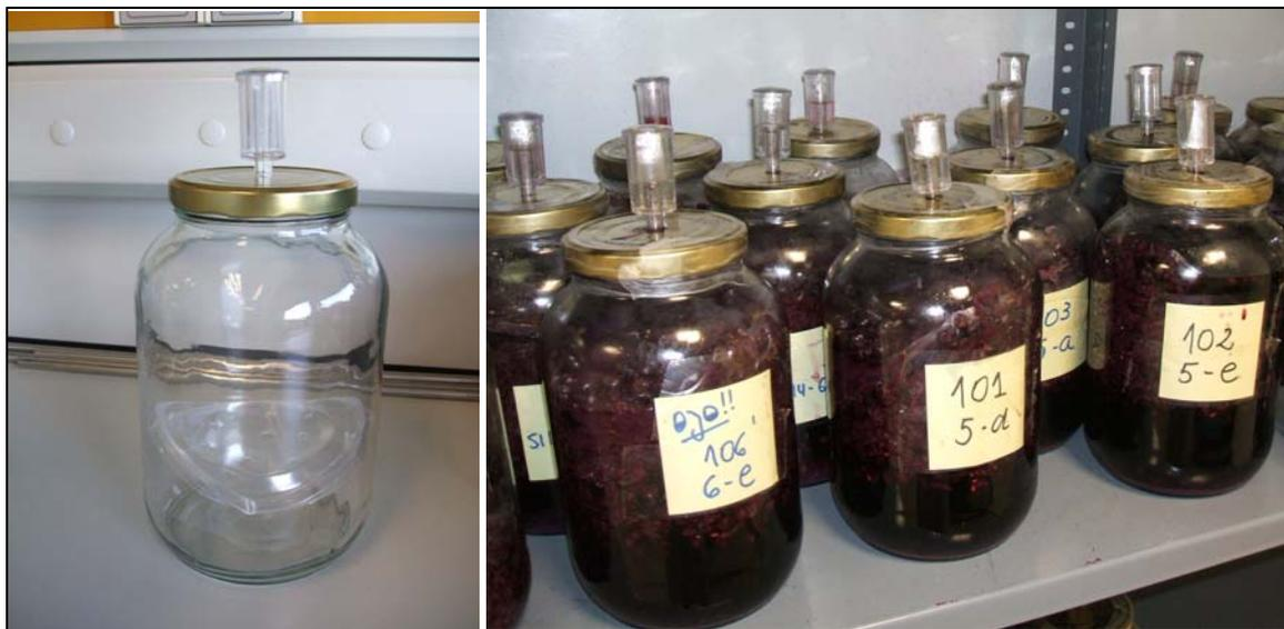
**Figura 3.17.** Micro-depósitos de fermentación utilizados para las vinificaciones experimentales. Diseño adaptado de Sampaio et al. (2007).
