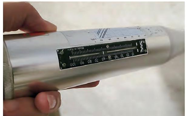
Fig. 1: índice de rebote. Esclerómetro Schmidt.
