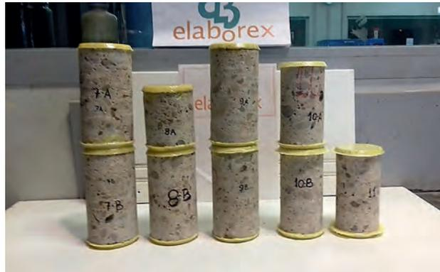
Fig. 5: probetas testigos de hormigón.
