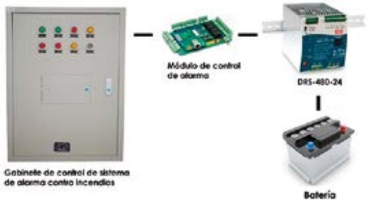
Figura 1. Gabinete de control de sistema de alarma contra incendios de 24V.
