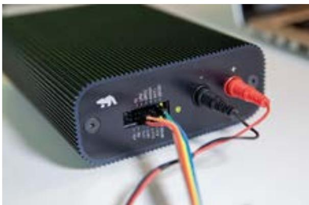
Imagen 6. El Qoitech Otti Arc, una unidad de medida de precisión de baja corriente (fuente: Qoitech).
