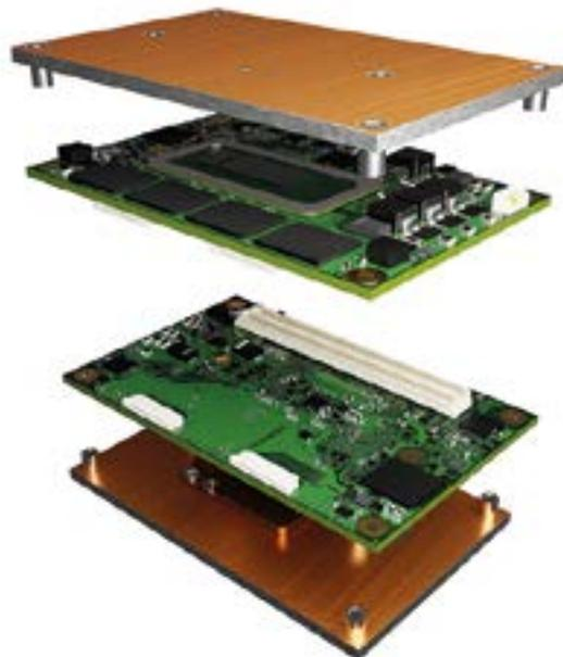
Figura 6. El TDP no es un reto: A pesar de su reducido tamaño, COM-HPC Mini ofrece un amplio margen para procesadores de alto rendimiento con un consumo máximo de hasta 76 vatios, mientras que los diseños de sistemas con COM Express Compact suelen admitir sólo hasta 45 vatios. Para permitir a los desarrolladores hacer el mejor uso posible del rango de potencia ampliado, congatec ofrece soluciones de refrigeración optimizadas.
