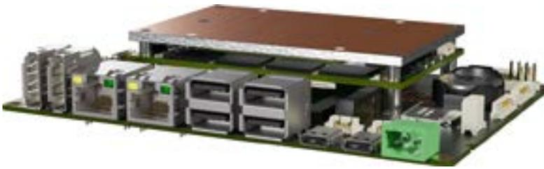
Figura 5. La altura ya no es un cuello de botella: Un diseño de módulo COM-HPC Mini y dissipador térmico tiene una altura mínima de 15 mm (desde la superficie de la placa base hasta el dissipador térmico). Es decir, 3 mm menos que la altura mínima del sistema de 18 mm para COM Express Compact.
