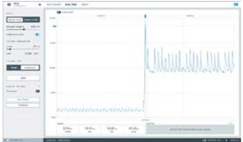
Imagen 5. Captura de pantalla de la aplicación Power Profiler durante una medición de corriente en tiempo real (fuente: Nordic).
