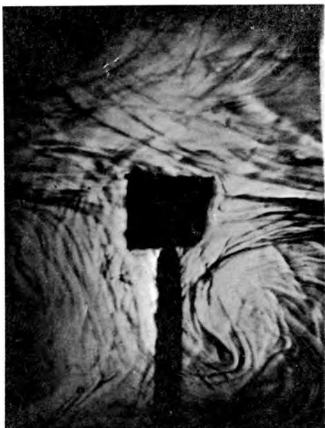
Fig. 8d.— Turbulencias generadas alrededor de un monocristal de ADP, al aumentar la velocidad lineal de la solución  $V_s = d) 1,74$  cm/seg.
