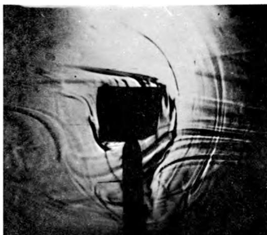
Fig. 8c.— Turbulencias generadas alrededor de un monocristal de ADP, al aumentar la velocidad lineal de la solución  $V_s = c) 1,15$  cm/seg.
