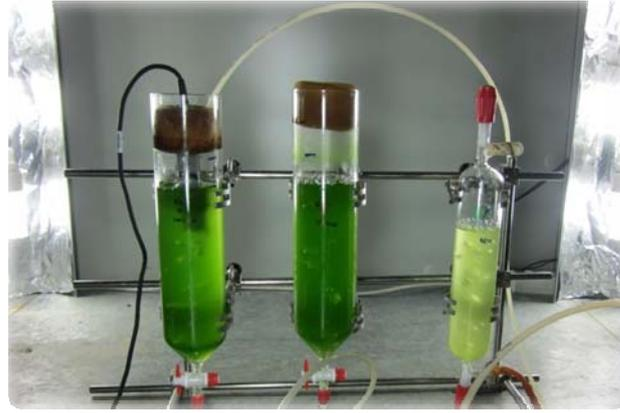
Figura 3. Fotografía de los fotobiorreactores tipo columna de burbujeo, utilizados en los ensayos
