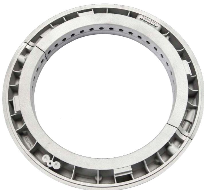
Las piezas impresas en 3D son dos juntas de sellado de aceite empleadas para separar el aceite del vapor en el interior de la turbina mediante aire presurizado.
