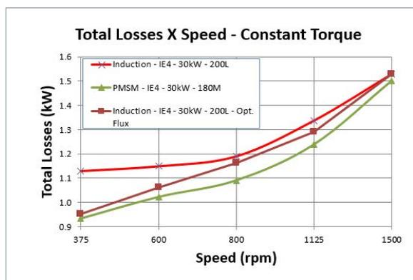
Figura 13. Curva pérdidas x velocidad en motores accionando cargas con par constante.
