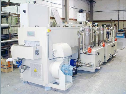
LCB / DC / LCA de Bautermic son máquinas tipo túnel continuo que permiten infinidad de tratamientos, ideal para trabajos en serie que requieran altas producciones. Las piezas son colocadas directamente sobre la cinta transportadora, en cestas o soportes especiales y se descargan en el extremo opuesto. La principal característica de este tipo de lavadoras es que permite la realización de tratamientos múltiples y está indicada para producciones medias y altas.
