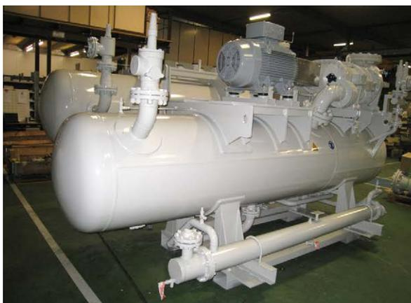
Figura 12. Motor de imanes permanentes de la marca WEG modelo Wmagnet accionando un compresor Mayekawa.
