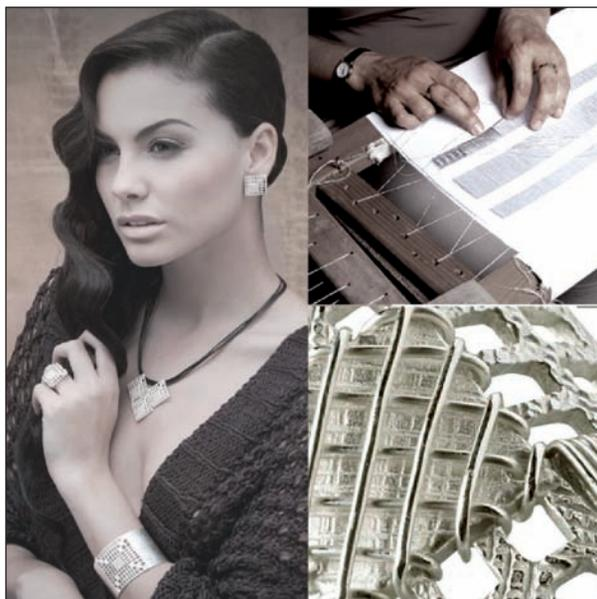
Un primer proceso de realización de las bases de las joyas mediante la técnica de fundición a la cera perdida y un segundo proceso, realizado manualmente, del enhebrado del hilo de plata sobre la base calada de la joya.
