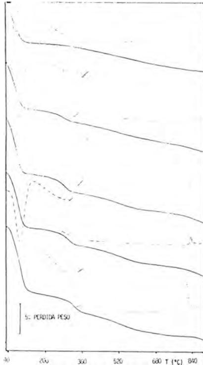
Figura 3: Curvas ATD y ATG (de abajo a arriba) sepiolita natural y tratada con HCl 1.25% durante 2, 6, 24 y 48 horas.
