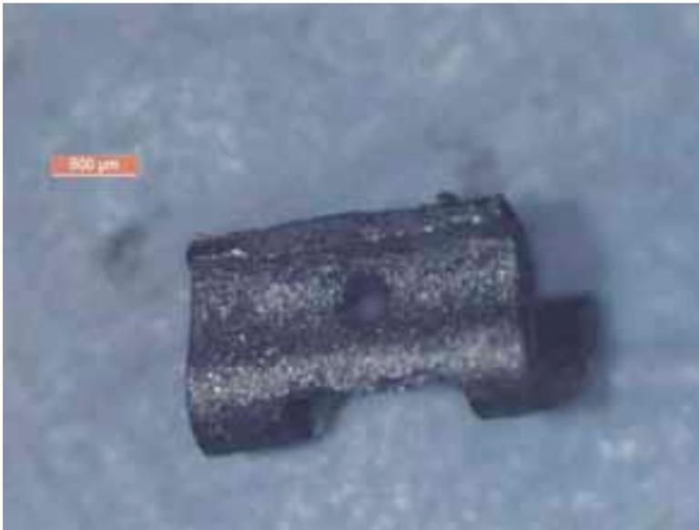
Figuras 3, 4 y 5. Imágenes del bracket dental terminado. Comparativa dimensional (izquierda) y vistas al microscopio de la base (centro) y la pieza de cierre (derecha).
