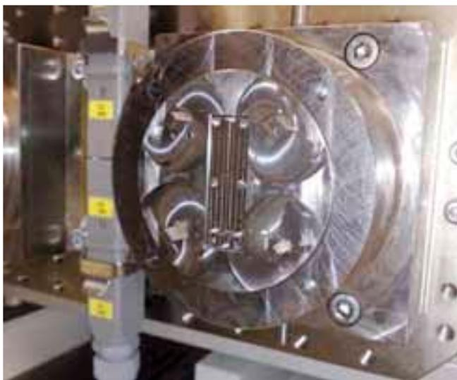
Figura 9. Micromolde para inyección de microchip de analítica.
