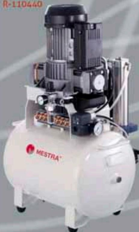
Los compresores MESTRA de tipo "BOXER" incorporan una nueva tecnología patentada que los hace mucho más fiables y silenciosos: se trata de pistones en disposición "boxer" (contrapuestos a 180°), unidos solidamente a través de una biela rígida y con un acoplamiento biela - cigüeñal mediante excéntrica.
