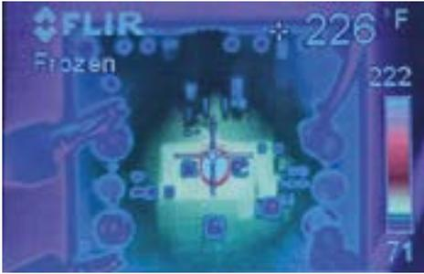
Figura 6. Disipación de una bobina saturada - 107.78°C (226°F).
