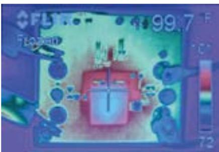
Figure 9. Disipación de una bobina dentro de su rango nominal de corriente 37.61°C (99.7°F).
