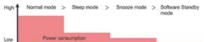
Figura 1. Comparación aproximada del consumo de energía en cada modo de bajo consumo (se aplican condiciones).
