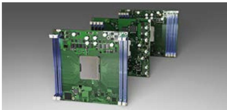
Figura 5. Al desplegar módulos de servidor COM-HPC, los fabricantes de equipos originales embebidos todavía tienden a utilizar el Size D con 4 ranuras de RAM. Esto se debe a que, normalmente, es necesario procesar muchos paquetes de datos pequeños en tiempo real en el extremo. Sin embargo, existen soluciones con 8 zócalos para necesidades de memoria mayores.
