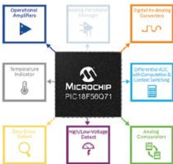
Figura 1. Los microcontroladores con periféricos analógicos integrados ayudan a los diseñadores a reducir el coste y el plazo de comercialización, así como a mejorar la capacidad de respuesta del sistema.
