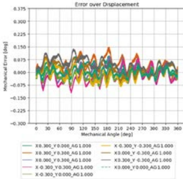
Figura 5. Error sobre el desplazamiento del eje X-Y.
