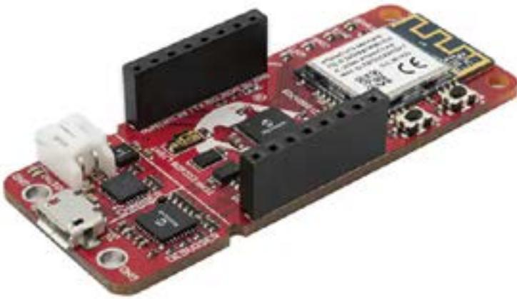
Figura 9. Placas como la PIC-IoT Board AC164164 ayudan a acelerar el desarrollo de la seguridad integrada mediante la integración de CI de seguridad preaprovisionados con credenciales para AWS o Google Cloud. (Fuente de la imagen: Microchip Technology).
