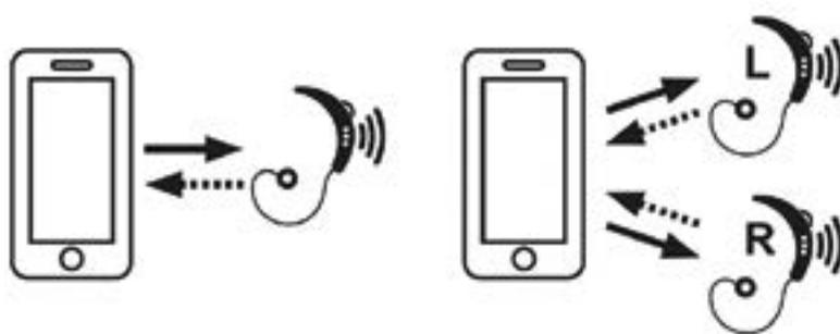
Figura 3. Con Auracast, un ALS se puede usar como un auricular, con un flujo de audio o con dos flujos separados para los ALS derecho e izquierdo.
