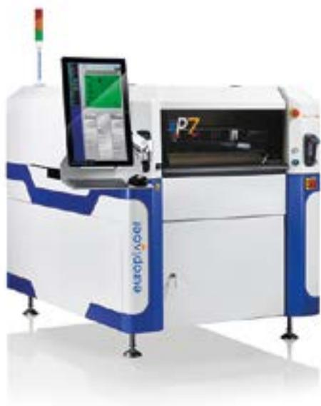
La nueva ii-P7 introduce una serie de mejoras de productividad que incluyen un cabezal de impresión sin mantenimiento con un sistema de control de impresión activo de bucle cerrado y programación de presión de impresión así como una calibración de espátula cero. La nueva plataforma admite tamaños de pantalla de 584 mm a 736 mm (de 23 a 29 pulgadas) sin adaptador, lo que reduce los tiempos de configuración y cambio en entornos de montaje de alta mezcla.
