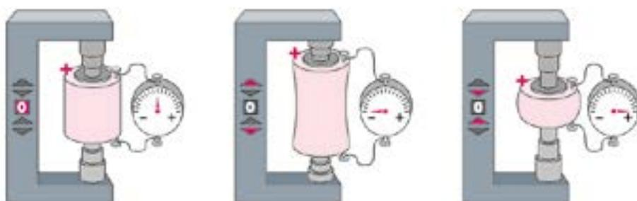
Figura 3. Efecto piezoeléctrico demostrado en materiales como el cuarzo.
