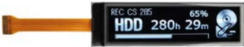
Imagen 5. Módulo de pantalla OLED de 2,1" ELW2106AA, de Futaba. (fuente: Futaba).
