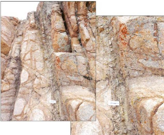
**Figura 10.** Fotos apiladas que exhiben un juego de vetillas paralelas de cuarzo macizo y suturado, de unos pocos cm de espesor, y otro de disposición oblicua, de mm de espesor, ambos inyectados en granito.
