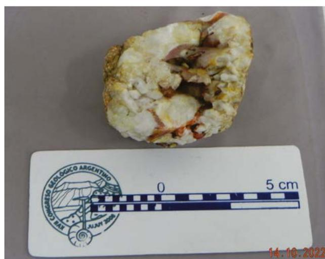
**Figura 12.** Cristales de cuarzo secundario obtenidos desde vetillas paralelas (Figura 10), en granito silicificado.
