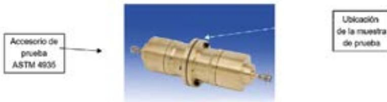
Figura 5. El accesorio de prueba coaxial que muestra la ubicación de la muestra para las pruebas ASTM D4935.
