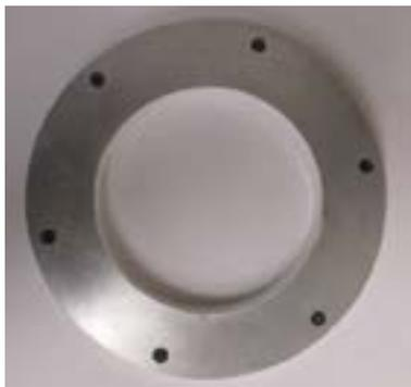
Figura 4. Para las pruebas con el Mini Box, un anillo de 100 mm de diámetro mantenía y comprimía la muestra de prueba en su lugar.
