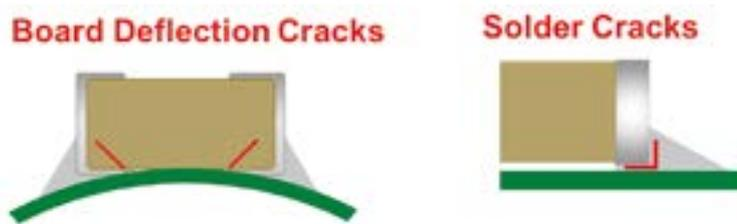
Figura 3: Formas comunes de fallos mecánicos para los MLCC debidas a la flexión del PCB.
