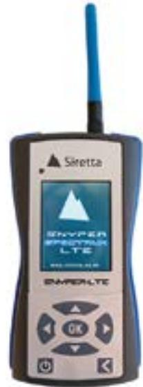
Figura 1. El SNYPER-LTE Spectrum proporciona una amplia variedad de datos que facilitan la selección de la antena y la optimización de la ubicación de los equipos inalámbricos móviles.
