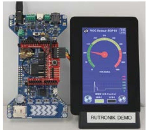
Figura 3. El Kit de Desarrollo RDK2 de Rutronik con un módulo de display inteligente. Fuente: Rutronik.
