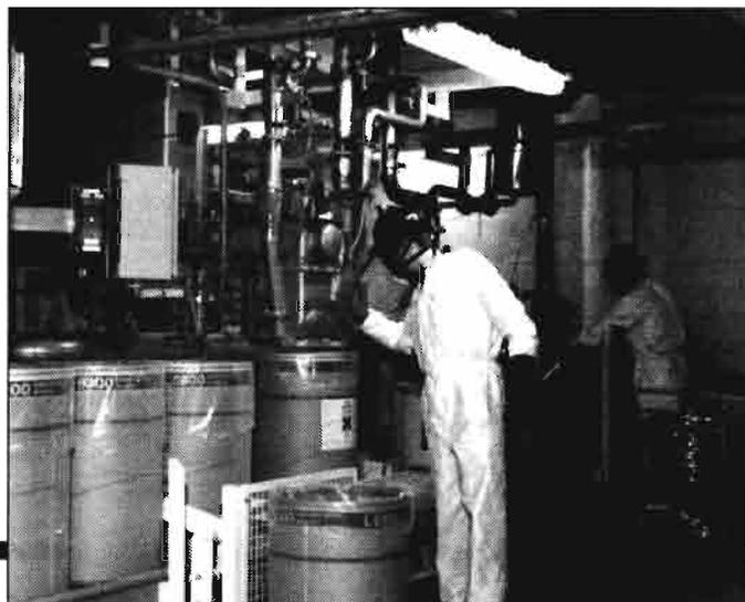
Vista parcial de la nave de envasado de sustancias activas. Una vez sintetizados, las sustancias activas se centrifugan y secan, para ser luego envasadas. En la imagen se está envasando la sulfonilúrea "L 5300", número de código del tribenurón técnico, sustancia activa para la formulación del GRANSTAR®, herbicida selectivo de los cereales, con el que, en España, se tratan unas cuatrocientas cincuenta mil hectáreas.
