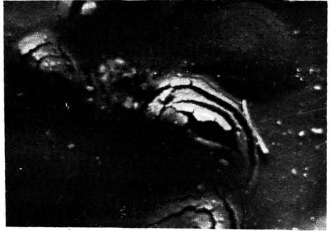
Fig. 17.-Microfotografía electrónica de barrido de la muestra tratada a 1000°C durante 3 h. (x 1000).
