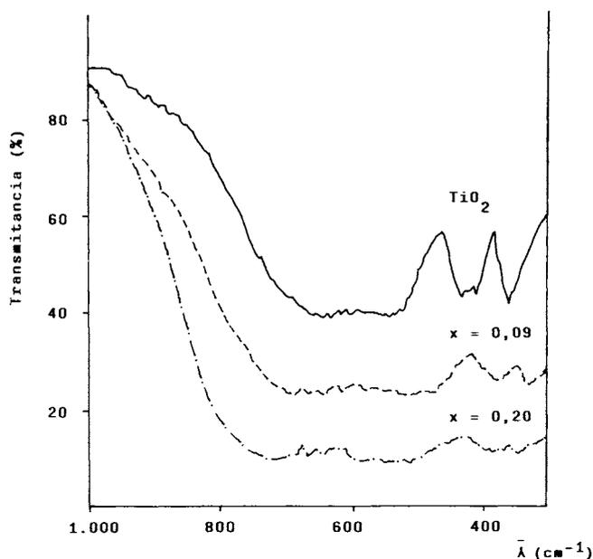
Fig. 5. Espectros IR de las muestras  $Cr_xTi_{1-2x}Nb_xO_2$  ( $x = 0,0; x = 0,09$  y  $x = 0,20$ ) calcinadas a  $1.200^\circ C$ .
