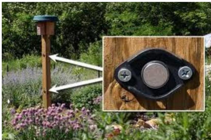
Fig. 2: Sensor de humedad y temperatura (iButton) utilizados en la estación de Faro. (Foto extraída de la página <http://ibutton.cl/que-es/>).
