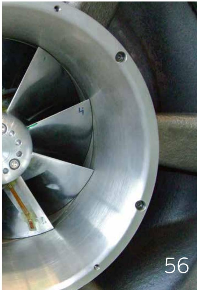
Turbocompresor A200-H de una sola etapa
