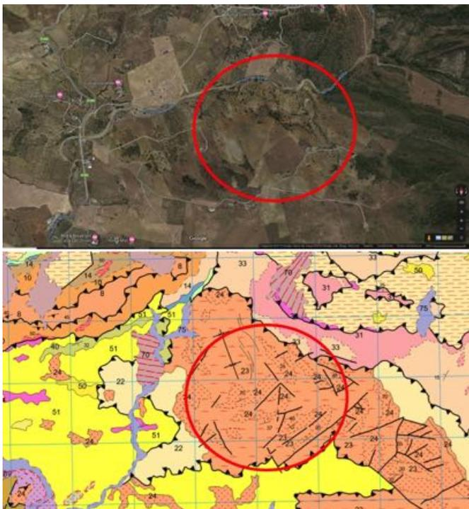
**Figura 4:** Imagen de satélite y cartografía geológica de la zona donde aparecen las marcas. El área marcada con el círculo corresponde a la unidad geológica en la que se ubican las supuestas “huellas” de homínidos de Álora. Los materiales aflorantes corresponden a depósitos de lóbulos turbidíticos de areniscas que alternan con depósitos autóctonos marinos de margas, de edad Mioceno inferior (aprox. 20 Ma). Fuente: J.M. García Aguilar.
