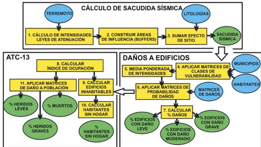
Fig. 1- Diagrama que representa de forma sintética las tres fases seguidas por la herramienta diseñada para la simulación de EDS. Como puede verse en la versión electrónica en color, los datos de entrada se muestran en azul, los de salida en verde y los procesos en amarillo.
