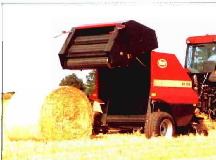
Foto 3. Rotoempacadora de cámara fija con rodillos metálicos. Documentación Vicon.
