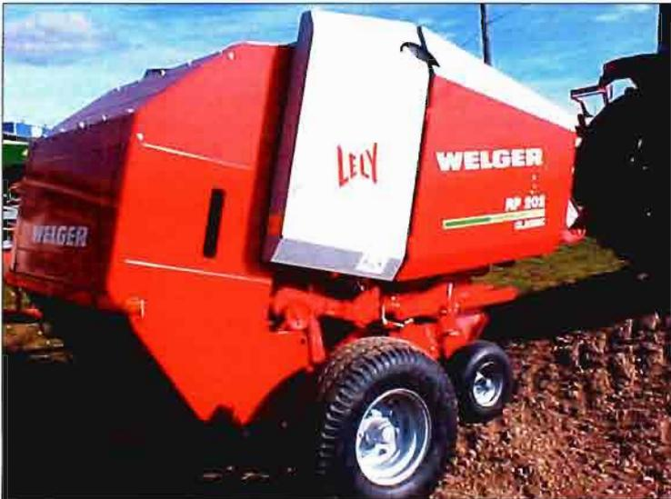
Foto 5. Rotoempacadora con cámara de rodillos metálicos. Documentación Welger.
