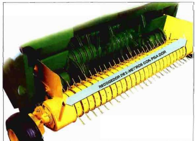
Foto 4. Cilindro recogedor con sistema picador. Documentación John Deere.
