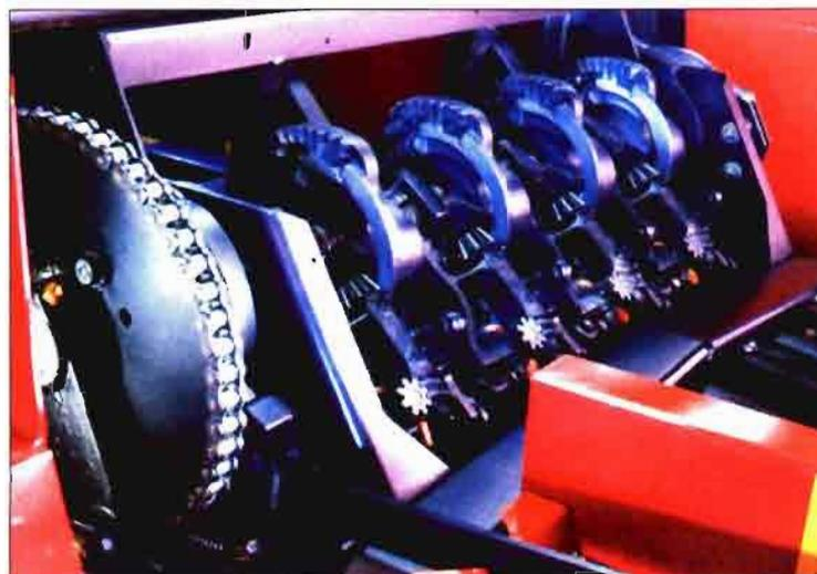
Foto 7. Sistema de atado de una macroempacadora con cuatro atadores. Documentación New Holland.
