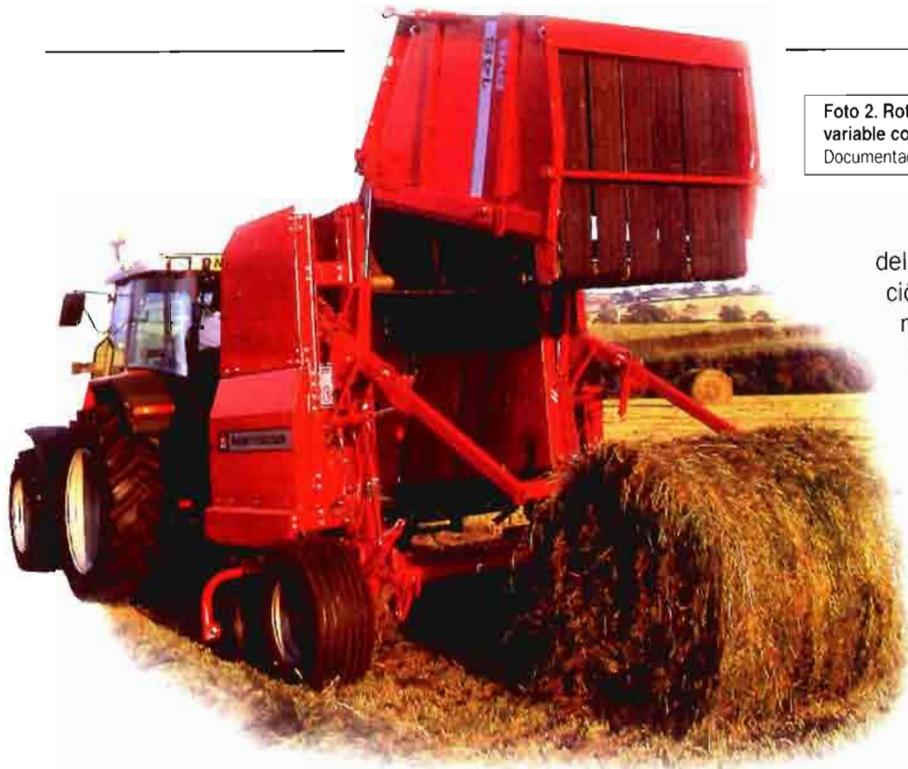
Foto 2. Rotoempacadora de cámara variable con correas de caucho. Documentación Massey Ferguson.
