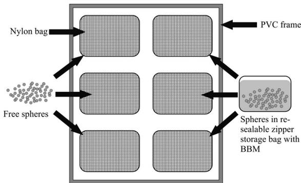
**Figure 1.** Diagram of the PVC structure for the experiments with immobilized algae carried out in aquatic ecosystems of the Sabana de Bogotá. *Esquema de la estructura en PVC para los experimentos con algas inmovilizadas llevados a cabo en los ecosistemas acuáticos de la Sabana de Bogotá.*
