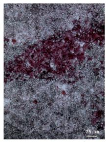
Fig. 4.- Doloesparita con cristales esferoidales de núcleos oscuros que rodean una forma lenticular parcialmente preservada rellena de esparita (teñida de rojo, oscura en escala de grises). Microscopio petrográfico. Nícoles paralelos
