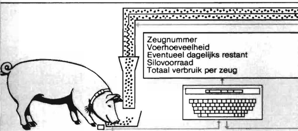
La electrónica, al servicio de la producción porcina. Sistema informatizado, acoplado a collar, para el control de la alimentación en regímenes de explotación intensiva. De "Hoko-Farm". Holanda.
