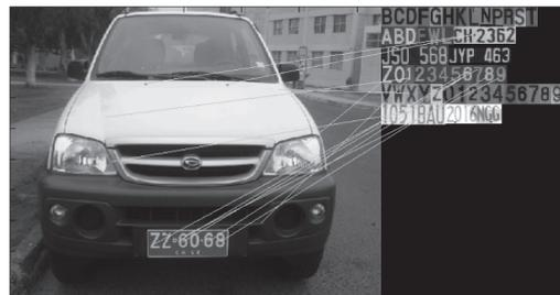
Figura 3. Puntos correspondientes entre la imagen de entrada y la imagen de referencia. (umbral = 0,80, puntos correspondientes = 39).
