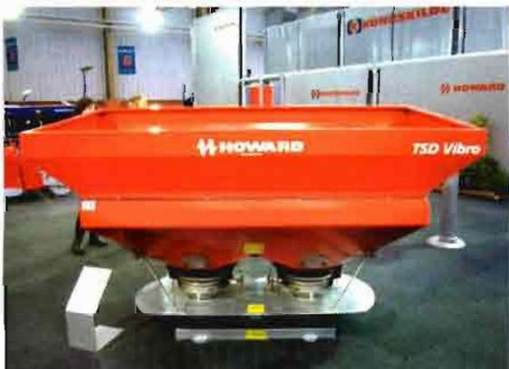
disco, se logra el movimiento del fondo de la tolva, provocando un efecto vibratorio que favorece la circulación y salida del abono, con independencia de su granulometría.
