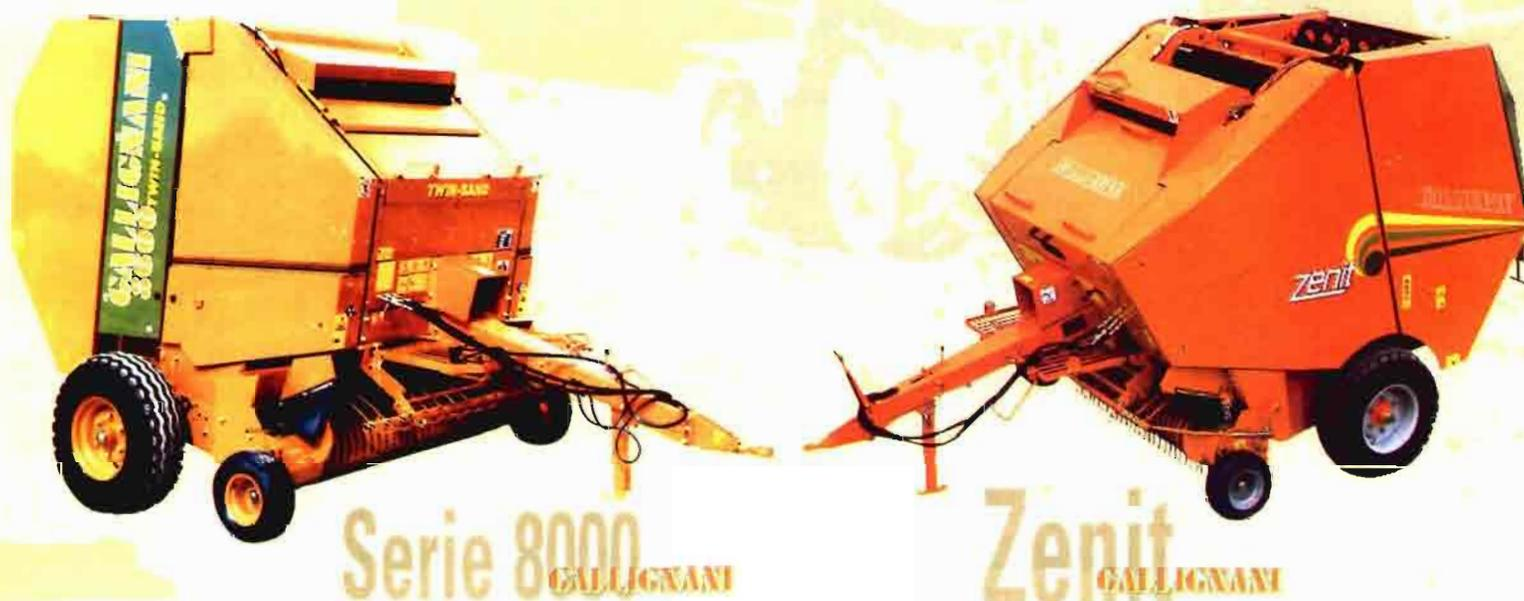
Concebida para recoger forraje para ensilar, combina las ventajas de la cámara fija, delimitada por un sector móvil delantero de rodillos-correas cortas, y de la cámara variable, con otro sector de rodillos-correas largas en la parte trasera. Todo ello para garantizar la
