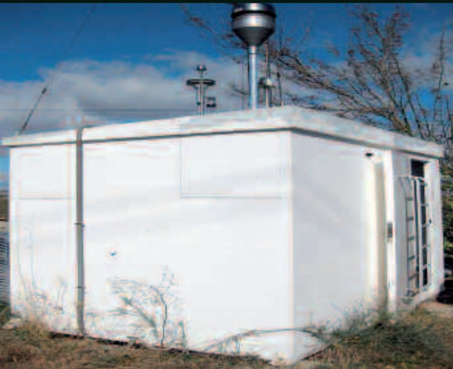
Estación de calidad del aire con cabezal de PM10.
