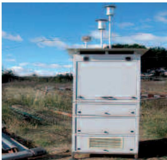
A la izquierda: Estación de calidad del aire con cabezal de PM10 y base meteorológica.
