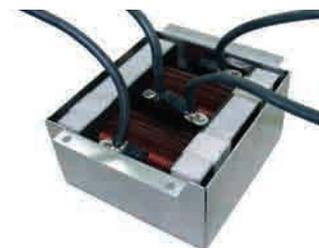
alta eficiencia para inversores solares y eólicos. Esta tecnología ha sido empleada tradicionalmente en otra aplicaciones, tales como soldadura, pero se ha demostrado totalmente adecuada para el diseño de choques en aplicaciones de conversión de energía en el campo de las renovables. Al reducir la RDC y RAC del choque, y al incrementar la frecuencia de resonancia, esta tipo de bobinado helicoidal permite a Premo ofrecer diseños precisos y eficientes.
