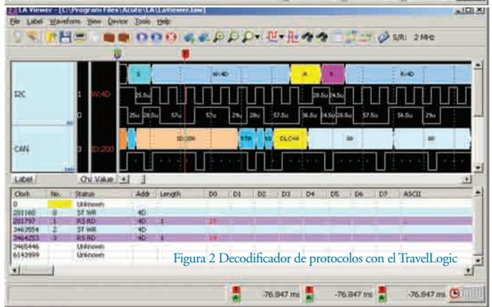
Figura 2 Decodificador de protocolos con el TravelLogic
