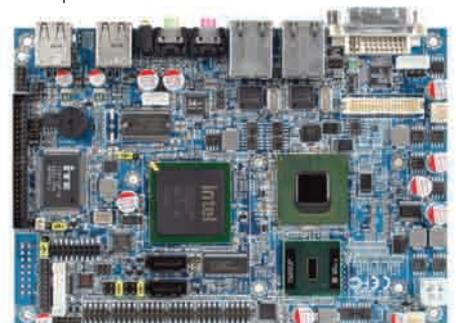
La placa EPIC dispone de un zócalo SODIMM capaz de soportar hasta 2 GB DDR2 400/533 de SDRAM
