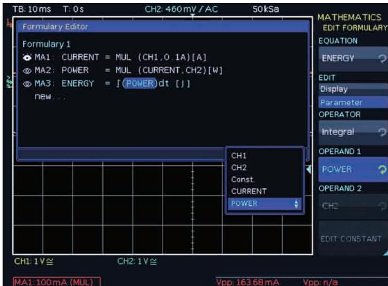
Figura 3. Definición de la ecuación de energía.
