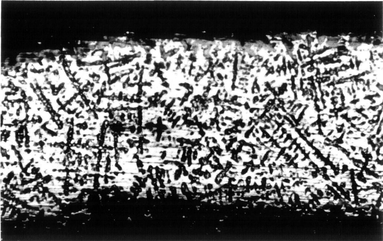
Lámina I. Metalografía en sección transversal de una placa de cinturón colada. Obsérvese la estructura dendrítica típica de fundición. (55 ×).
