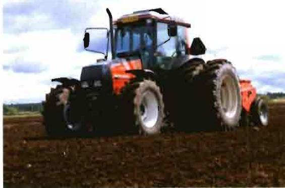
Gama formada por cuatro modelos polivalentes que llegan con una nueva conexión suave de la toma de fuerza. Sistema electrohidráulico con cuatro posiciones y nuevo freno en el eje delantero combinado con el freno de remolque. El modelo 900, de 90 CV, aumenta el par de 330 a 350 Nm.
