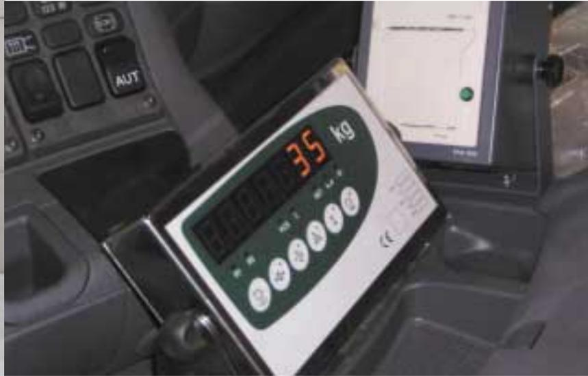
Detalle del brazo articulo con bascula, en el interior del camión se registra la pesada, y mediante una pequeño informe se controla la carga del camión.
