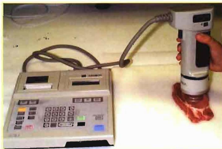
Medición del color en una muestra de lomo (*Longissimus dorsi*) mediante colorímetro Minolta.
