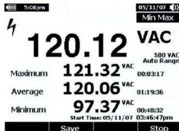
Esta sencilla función nos permite, por ejemplo, determinar de una forma muy sencilla la magnitud de una perturbación eléctrica y cuando se produjo la misma.
