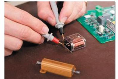
La medida de pequeñas resistencias (resistencia de bobinas de relees, etc.) implica minimizar la influencia del sistema de prueba en el propio circuito.
