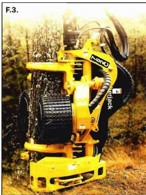
cabezal empieza a actuar como procesador. Mediante la acción combinada de unos rodillos dentados, que mueven el árbol horizontalmente (sistema de alimentación) y las garras anteriores de sujeción (sistema de desramado), el cabezal realiza el desramado. Al mismo tiempo y a la longitud deseada o programada, el árbol es tronzado con la misma sierra de cadena empleada para el apeo (sistema de tronzado). La operación finaliza cuando se llega a la copa y el cabezal arroja la "punta" aparte.
