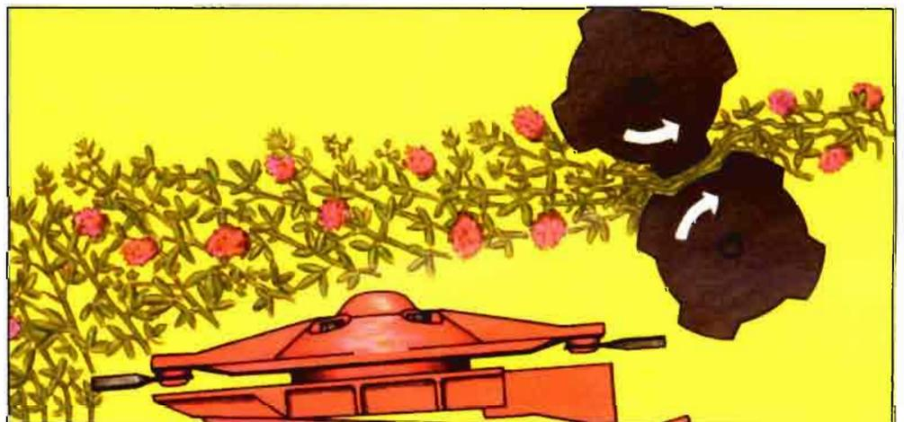
Fig.5 : Modo de trabajo de una segadora-acondicionadora de rodillos de caucho acanalados. Documentación Kuhn.
