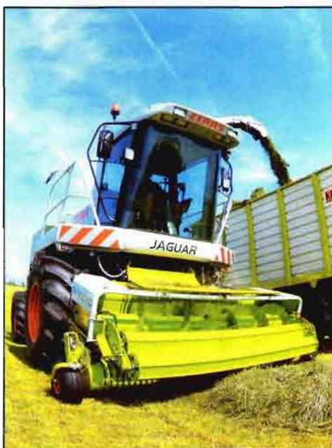
Fig. 7 : Cosechadora autopropulsada con cabezal de recogida de forraje. Documentación Claas.
