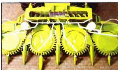
Fig. 8 : Cabezal multilinea, independiente de la dirección de las líneas del cultivo. Documentación Claas.
