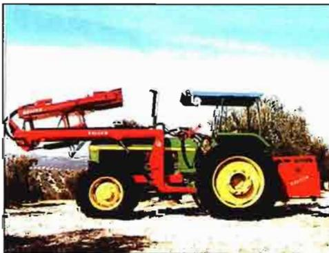
Fig. 6. Vibrador de troncos replegado sobre el tractor para favorecer el transporte.
