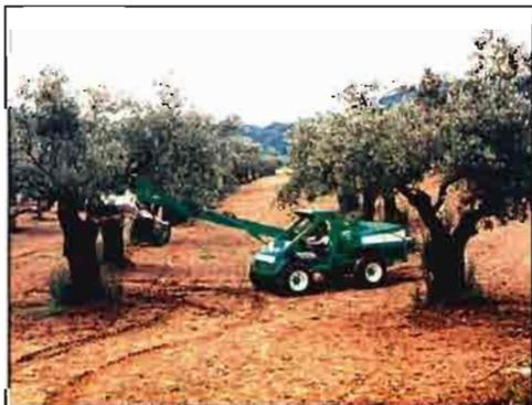
Fig. 4. Vibrador multidireccional autopropulsado por su propio vehículo.
