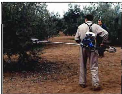
Fig. 1. Peines oscilantes accionados por un motor y un compresor que el operario lleva en la espalda.
