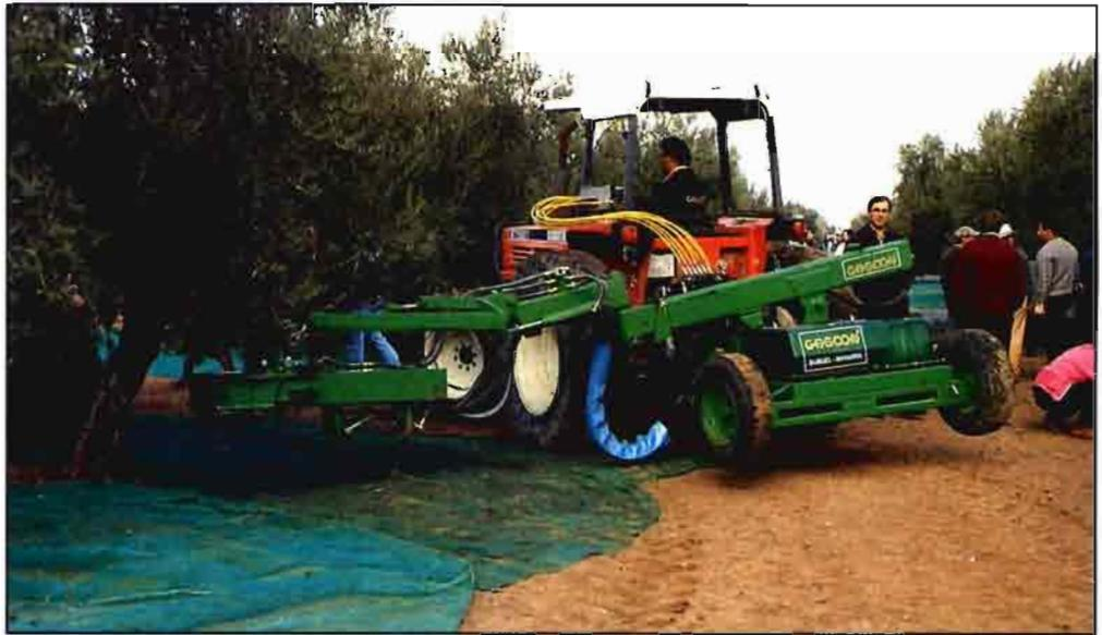
Fig. 5. Vibrador de troncos situado en una plataforma tras el tractor.
