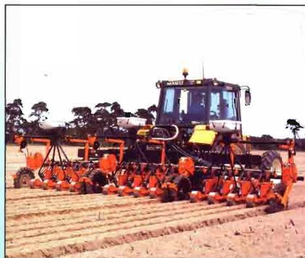
**máticas modelo Singulaire 785 en diferentes versiones.** En la foto del cuerpo sembrador vemos la buena selección que hace la sembradora Stanhay en tres líneas de siembra.
